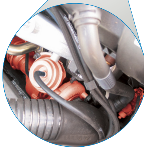
Transdutor de pressão e turbocompressor com turbina de geometria variável (destacados em vermelho) no Audi A4 TDI
