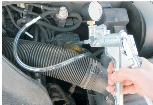
Verificação de um transdutor de pressão com a bomba de vácuo manual em um VW Golf IV (Número do produto Pierburg 12 00001 11 900)
